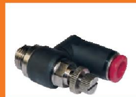
Banjo regulador de caudal orientable (regulación en la salida)
